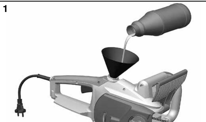
Die Kettensäge darf niemals ohne Kettenöl betrieben werden, da dies zur Beschädigung von Kette, Schwert und Motor führt. Bei Betrieb ohne Kettenöl wird im Falle der Beschädigung jeder Garantieanspruch abgelehnt.
