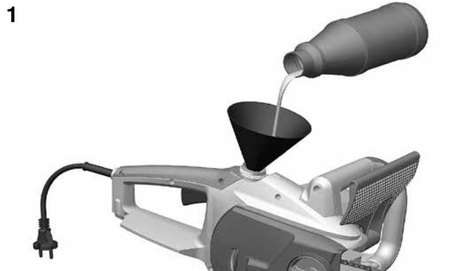
La tronçonneuse ne doit jamais être utilisée sans huile pour chaîne, vous risqueriez d'endommager la chaîne, la lame et le moteur. Tout endommagement dû à une utilisation sans huile de chaîne entraînerait la suppression du droit à la garantie.
